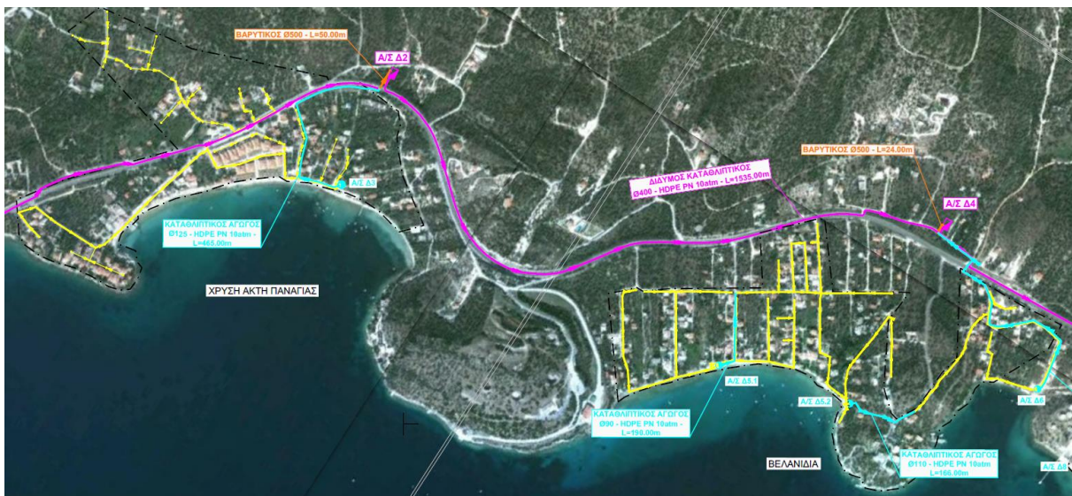
Υποέργο [1]: 'Κατασκευή Δικτύου Αποχέτευσης Ακαθάρτων στους Οικισμούς Χρ. Ακτή Παναγίας και Βελανιδιά Δ. Βόλου'
